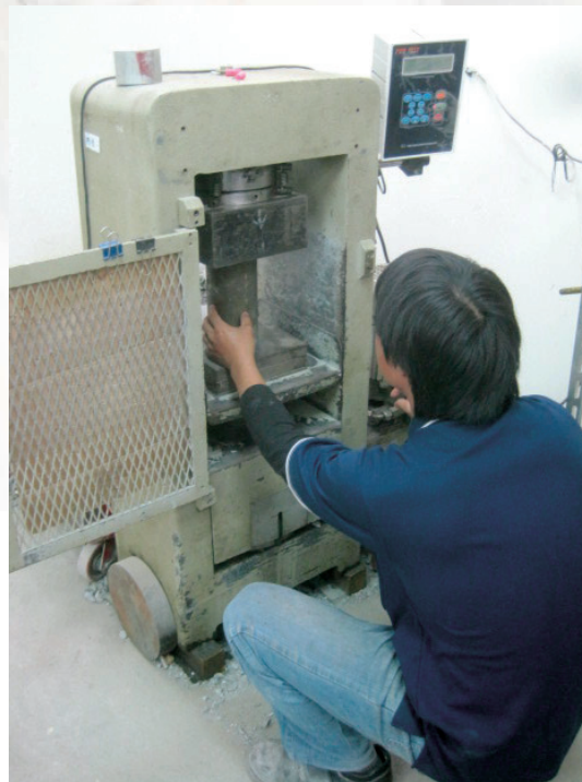
抗壓機 (200噸) Compression machine (200 ton)
