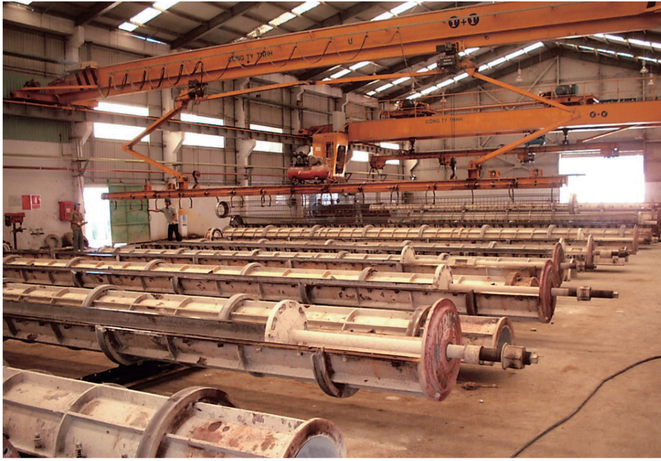
電動天車 Automatic crane
