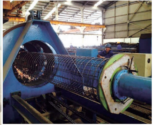
預力鋼棒自動焊接機 PC bar automatic welding machine(300~800)
