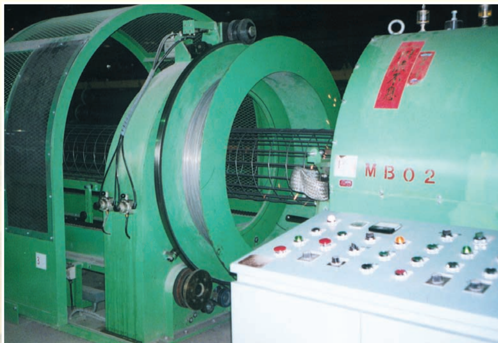
預力鋼棒自動焊接機(300-1200) PC bar automatic welding machine(300-1200)
